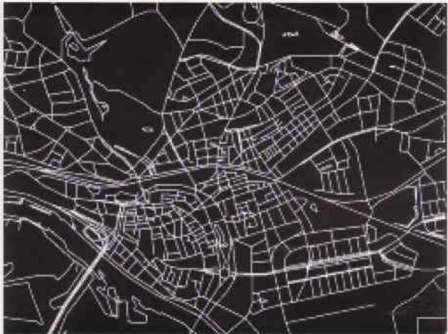
Een wegennetwerk in de vorm van een hartlijkenbestand. Het gaat hier om hetzelfde gebied als in figuur 1.
